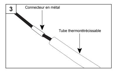
4. Tenez une torche à une distance d'environ 15,24 cm du centre du tube et déplacez-le dans un mouvement de va-et-vient. Chauffez un tube à la fois jusqu'à ce que le joint soit scellé. Pendant le processus de chauffage, gardez tous les autres fils et tubes à l'écart de la chaleur afin d'éviter qu'ils ne fusionnent. Évitez de surchauffer les tubes, car ils pourraient devenir cassants. Lorsque du liquide s'écoule de l'extrémité du tube, le joint devrait être scellé. (Fig 4)
