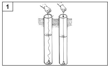
2. Le niveau le plus bas admis pour l'exploitation d'un réservoir constitue le niveau le plus bas de l'eau du puits après que la pompe soit mise en marche. Si vous connaissez le niveau le plus bas admis pour l'exploitation de votre réservoir, la pompe peut être réglée à un niveau inférieur à celui-ci de 6,1 m. Toutefois, la partie inférieure du moteur doit se trouver à au moins 3,05 m du dessus de la grille du puits. (Fig. 2)
