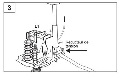
4. Raccordez les deux fils du branchement électrique général aux bornes extérieures du pressostat (L1 et L4). (**Fig. 4**)
