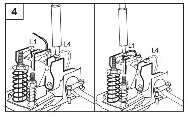
Acheminez le câble de la pompe à travers le trou restant situé sur le côté du pressostat et serrez le réducteur de tension pour fil électrique.
