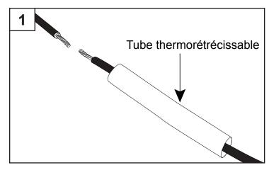
2. **REMARQUE**: Glissez chacun des fils qui ressortent de la pompe (y compris le fil de mise à la terre vert) dans une extrémité d'un connecteur en métal de la trousse de jonction. Glissez ensuite l'extrémité dénudée du câble électrique dans l'autre extrémité du connecteur en métal. Le connecteur devrait être centré sur les deux fils. Serrez le connecteur en métal jusqu'à ce qu'il se referme fermement sur les deux extrémités. (**Fig 2**)
