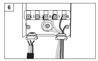
7. Raccordez les deux fils du pressostat aux bornes de la boîte de commande (L1 et L2). (Fig. 7)
