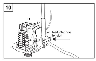
12. Acheminez le câble de la boîte de commande à travers le trou restant situé sur le côté du pressostat et serrez le réducteur de tension pour fil électrique.
