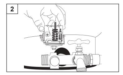
Acheminez le câble du branchement électrique général à travers l'un des trous situés sur le côté du pressostat et serrez le réducteur de tension pour fil électrique.
