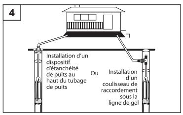
4a. Installation du coulisseau de raccordement. Le coulisseau de raccordement doit être installé sous la ligne de gel et sur le côté du tubage de puits, à l'endroit où la conduite d'alimentation ressort du puits, conformément aux instructions du fabricant. (Fig. 4a)
